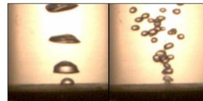
超音波による液体中ガス気泡の微細化
